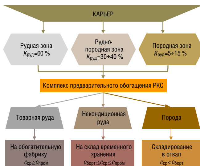
Рис. 4. Схема формирования грузопотоков с заданными качественными характеристиками
