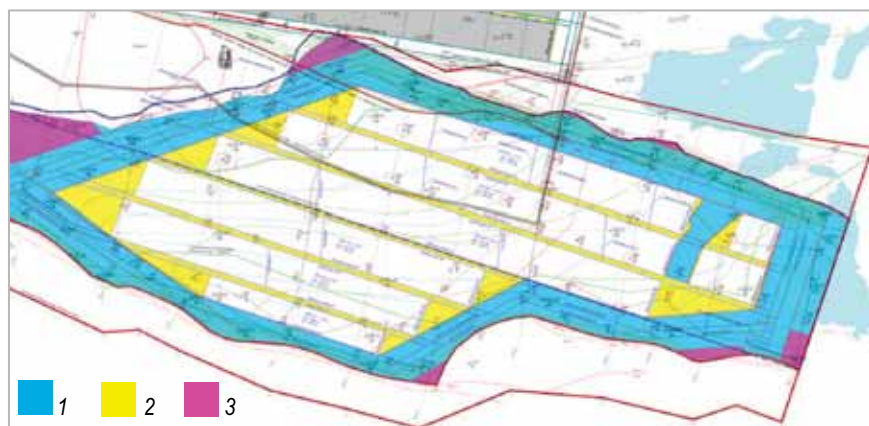
Рис. 1. Ситуационный план шахтного поля с отображением потерь полезного ископаемого, в том числе в охранных целиках (около капитальных горных выработок, под водоемом и др.):
