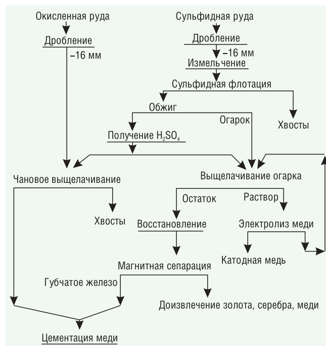
Рис. 5. Технологическая схема переработки руд на медном комбинате Lakeshore (США)
