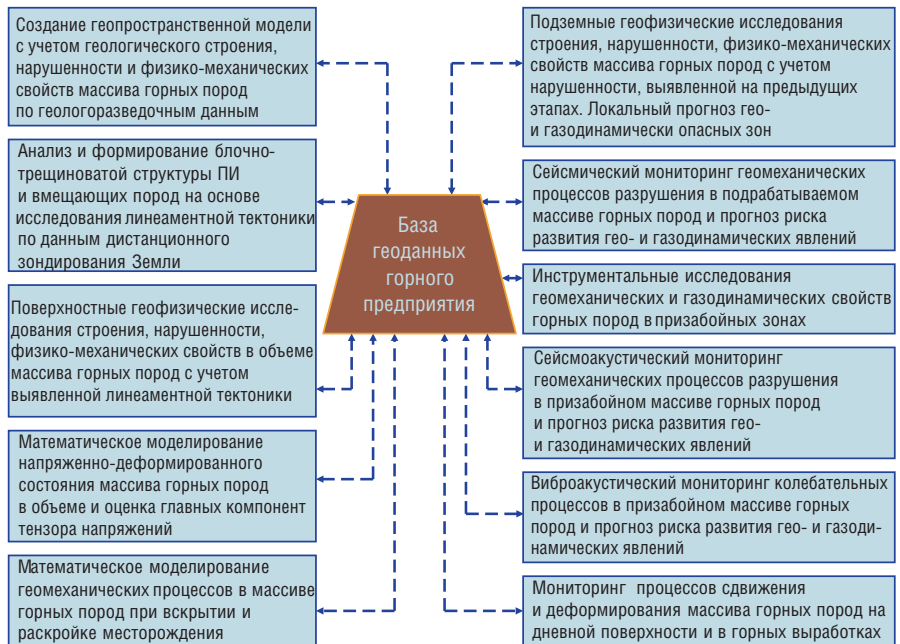
Рис. 1. Структура геоинформационного обеспечения и комплексного мониторинга гео- и газодинамических процессов при высокоинтенсивной подземной добыче угля
