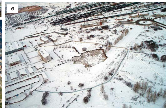
Техногенные нарушения земной поверхности вследствие накопления в недрах техногенных пустот при разработке калийных пластов Верхнекамского месторождения калийно-магниевых солей: а — 1-й провал над затопленной шахтой БКПРУ-3, образовавшийся 24.07.1987; б, в — 2-й провал на промплощадке БКПРУ-1, образовавшийся в июле 2007 г., и его размеры в ноябре 2008 г.; г — 3-й провал на ж.-д. путях станции Березники, образовавшийся 25.11.2010 (фото 26.08.2011); д — затопленные 2-й и 3-й провалы; е — 4-й провал, образовавшийся 04.12.2011 севернее здания АБК БШСУ (фото 16.02.2012)
