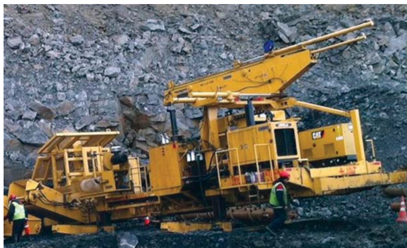
Бурошнековая установка на Юньягинском угольном разрезе. 2013 г.
