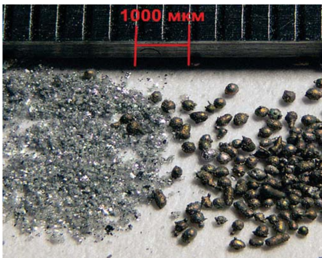
Частицы алюминиевой пудры ПП-1 (слева) и крупнодисперсного порошка алюминия ПА-2 (справа)
