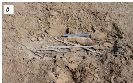
Полигонные испытания гранулитов на полноту детонации заряда в стальной трубе – моделирование заряда в шпуре:
